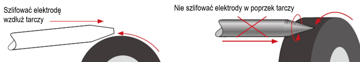
Rys. 16. Szlifowanie elektrody wolframowej
